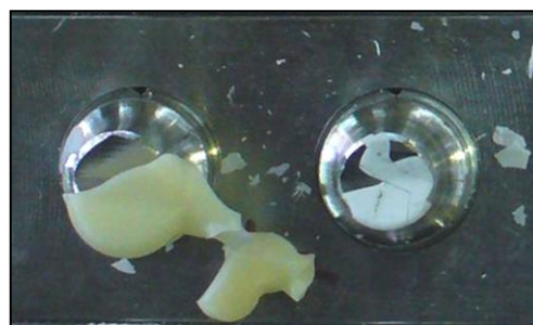
Fig. 155. Imagen de la fractura que se produjo en el núcleo de puente de la probeta nº7 del grupo Lava™
