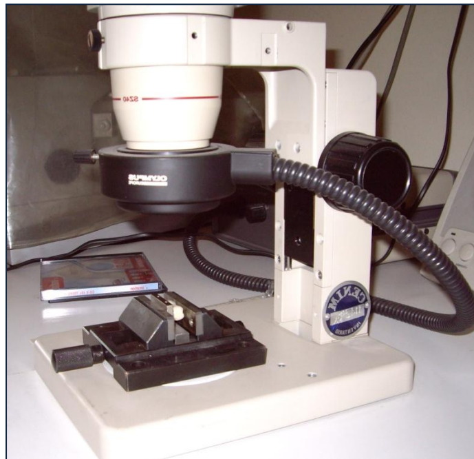
Fig. 85. Probeta del grupo Cercon en la mordaza de posicionamiento preparada para su análisis
