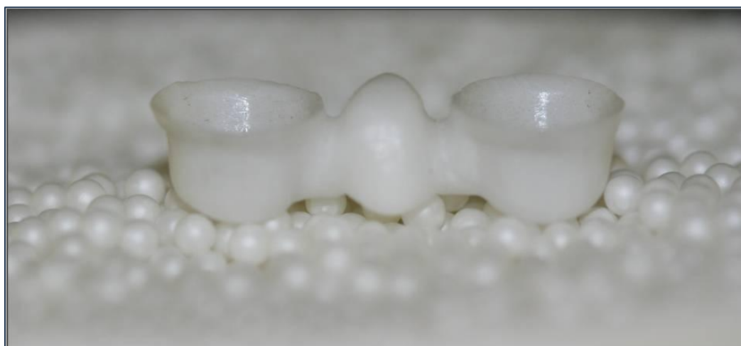
Fig. 63. Probeta nº 1 de YZ sobre las partículas esféricas de la bandeja de sinterización
