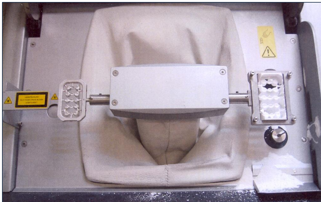
Fig. 32. Fresado de las estructuras de puentes partir de un bloque de cerámica presinterizado Cercon® Base 47mm.
