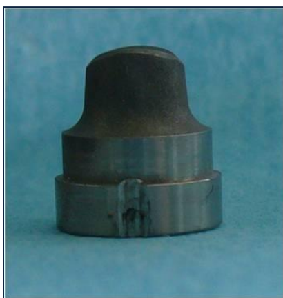
Figs. 12 y 13 Detalles de los muñones mecanizados de acero
