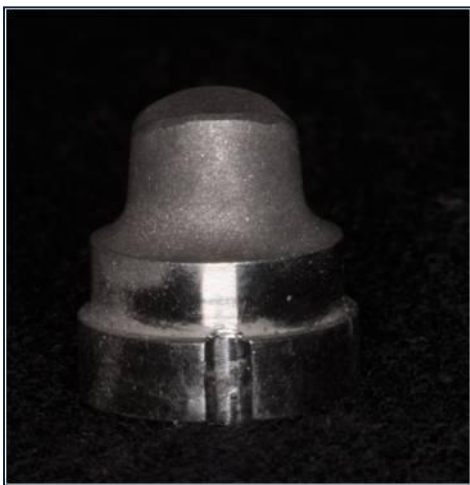
Figs. 14-15 Detalles de los muñones mecanizados de acero
