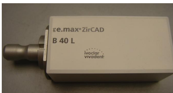
Fig. 69. Imágenes del bloque B 40 L de IPS e.max® ZirCAD para Cerec® empleado en el estudio
