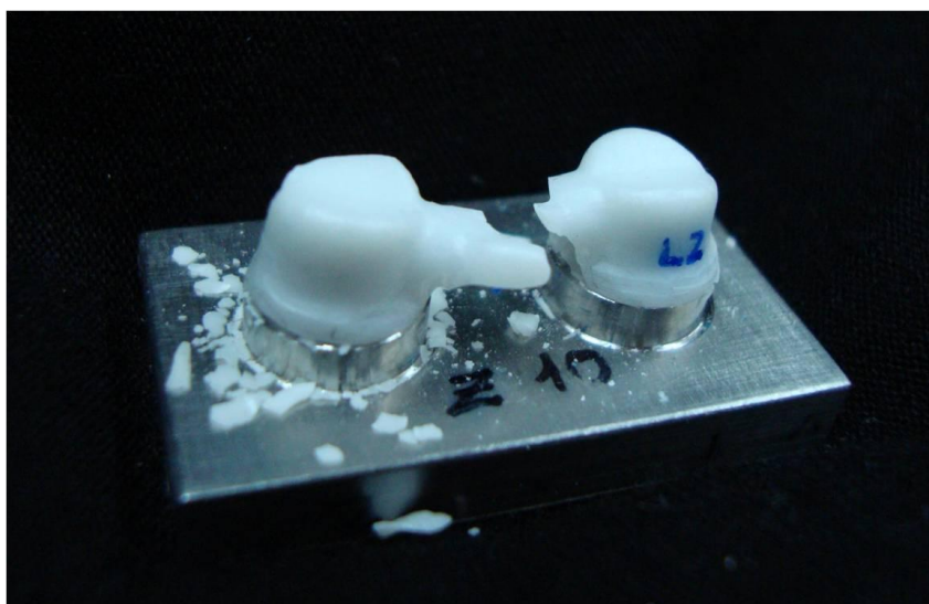
Fig. 153. Imagen de la fractura que se produjo en el núcleo de puente de la probeta nº10 del grupo IPS e.max ZirCAD
