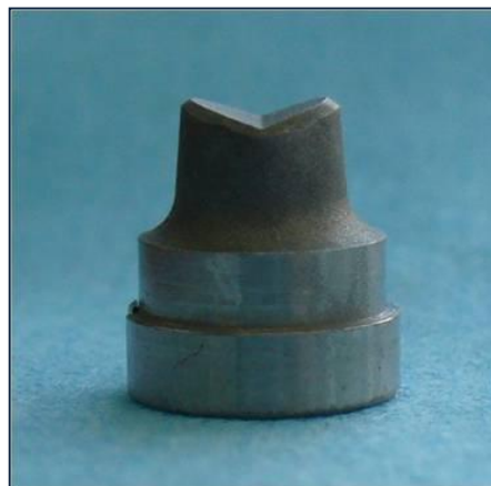
Figs. 12 y 13 Detalles de los muñones mecanizados de acero
