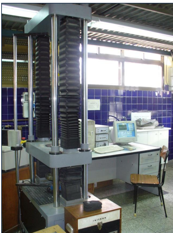
Figs. 96 y 97. Unidad para el ensayo mecánico y equipo informático que registra los datos
