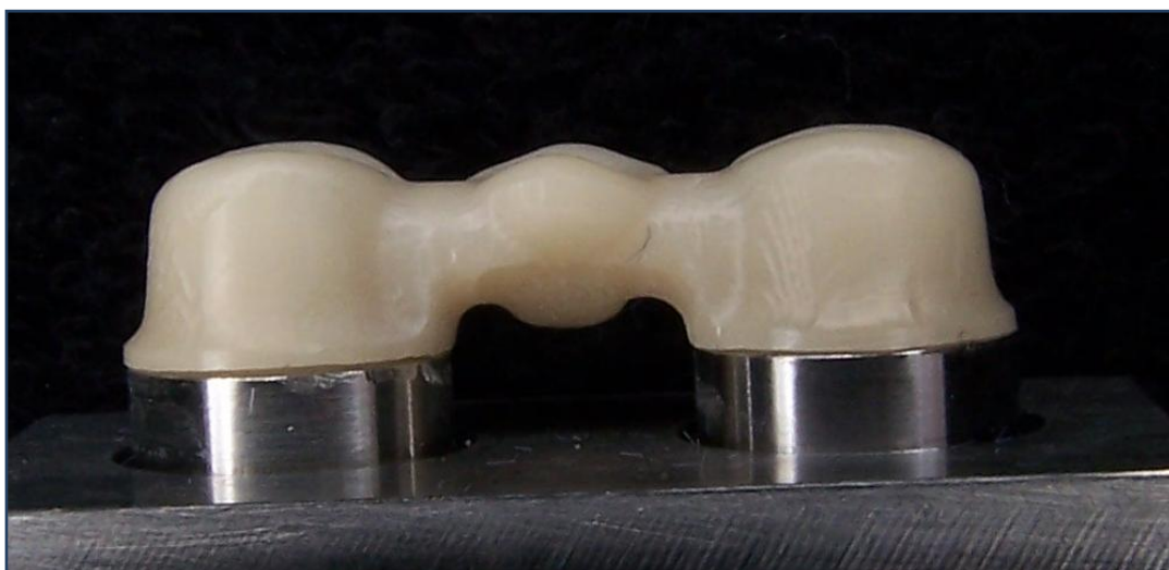
Fig. 50. Estructura para puente de tres piezas obtenida con el sistema Lava™ All Ceramic System. Probeta nº 1
