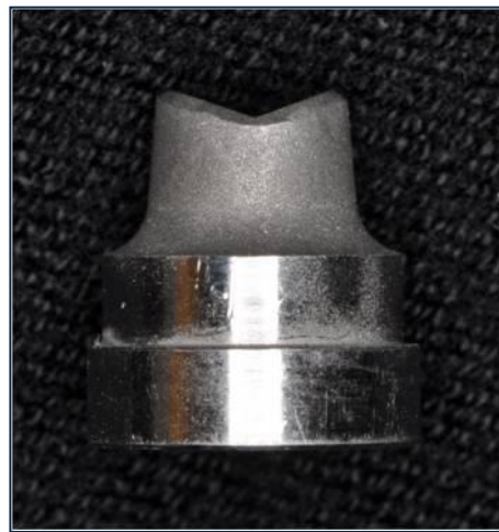
Figs. 14-15 Detalles de los muñones mecanizados de acero
