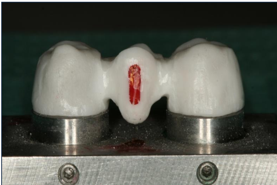
Fig. 34 Estructura para puente de tres piezas obtenida con el sistema Cercon Smart Ceramics® a partir del encerado de dicha estructura. Probeta nº 1
