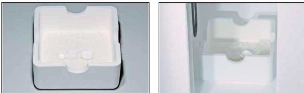
Figs. 61 y 62. Bandejas con bolas para la sinterización inLab
