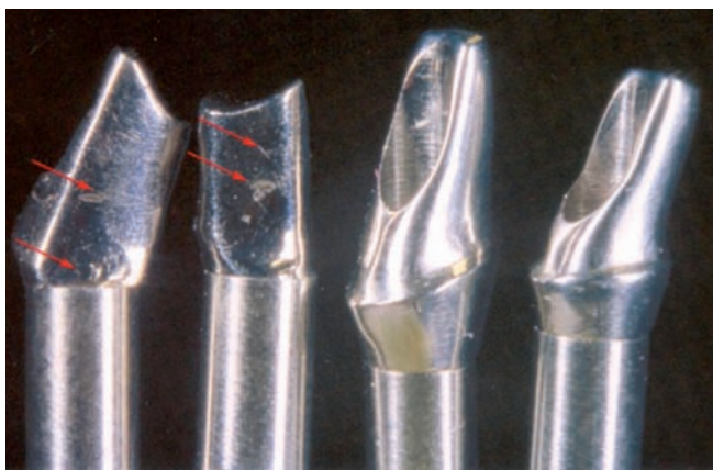
Figura 2. Izq.: dos pilares individualizados colados. Dcha.: dos pilares Procera® de titanio puro, escaneados y fresados; obsérvese la gran precisión en relación al ajuste marginal y la ausencia de porosidades y defectos
